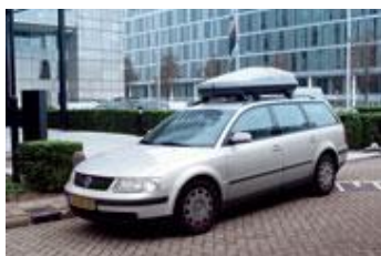
Figuur 56 – De weerstand van de lucht F_{w,l} hangt ook af van het frontaal oppervlak en de stroomlijn.
