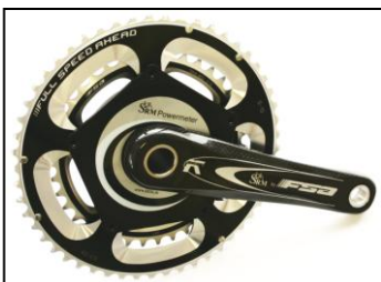
Figuur 39 – Het SRM-systeem zit verborgen in de trapas.
