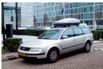
Figuur 53 – De wrijvingskracht van de lucht F_{w,l} hangt ook af van het frontaal oppervlak en de stroomlijn.
