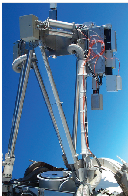
Obrázok 2. Veža a DOT počas pozorovania (vľavo). Primárne 45-cm zrkadlo a sústava kamier vedľa primárneho ohniska (uprostred). Primárne ohnisko s vodou chladeným šikmým zrkadielkom odrážajúcim väčšinu obrazu Slnka mimo teleskop (vpravo). Malá dierka uprostred prepúšťa časť svetla do sústavy filtrov.
