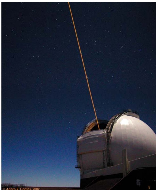
Obr. 5 Laserový lúč adaptívnej optiky teleskopu Keck počas pozorovania. Lúč je voľným okom neviditeľný a zachytí ho len snímka s dlhým expozičným časom.
