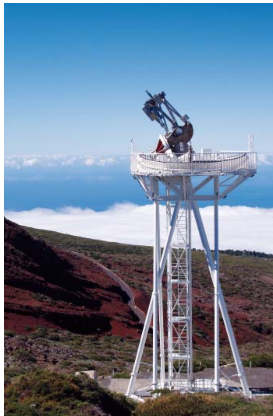
Obr. 6 Holandský otvorený teleskop DOT (Dutch Open Telescope) na ostrove La Palma je príkladom moderného slnečného teleskopu s otvorenou rámovou konštrukciou, ktorý poskytuje časové série multispektrálnych obrazových pozorovaní slnečnej fotosféry a chromosféry.
