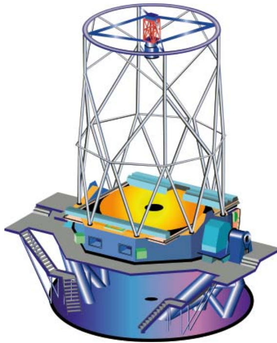
Obr. 4 Teleskop Gemini s priemerom zrkadla 8,1 m je príkladom veľkého moderného astronomického teleskopu s otvorenou rámovou konštrukciou na altazimutálnej montáži.
