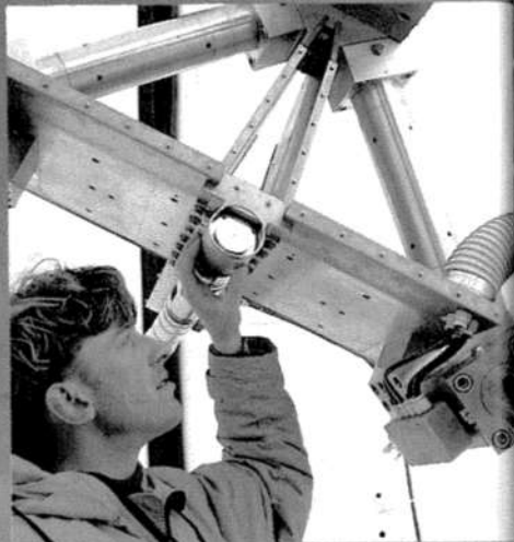
Felix Bettonvil, een ingenieur in het DOT-team, bekijkt kort na de First Light Ceremony de kop van de DOT. Het spiegeltje zit in het primaire brandpunt en weerkaatst het grootste deel van het invallende zonlicht. Alleen het kleine gaatje laat licht toe tot de koker erachter. Daarin zitten een microscoopobjectief voor navergroting, filters en de CCD-camera die de eerste beelden maakte. Inmiddels wordt complexere secundaire apparatuur geïnstalleerd, waarbij een deel van het licht na het diafragma naar opzij wordt gebracht, waar meer ruimte is, bezijden de inkomende bundel. De slang rechts dient voor luchtafzuiging en bevat ook de waterleiding die de koeling van de achterkant van het spiegeltje verzorgt.
