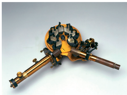
Figuur 2. Lockyer's hoge-dispersie spectroscop. De buis linksonder begint met een in breedte verstelbare spleet waarop een zonsbeeld werd geprojecteerd. Het licht doorliep dan zeven achtereenvolgende prisma's om een grote dispersie (uitrekking in golflengte) te krijgen. De buis rechts bevat een kleine telescoop om het spectrum te bekijken, met een precisieschroef en een loep op de verdeling om golflengtes te bepalen.
