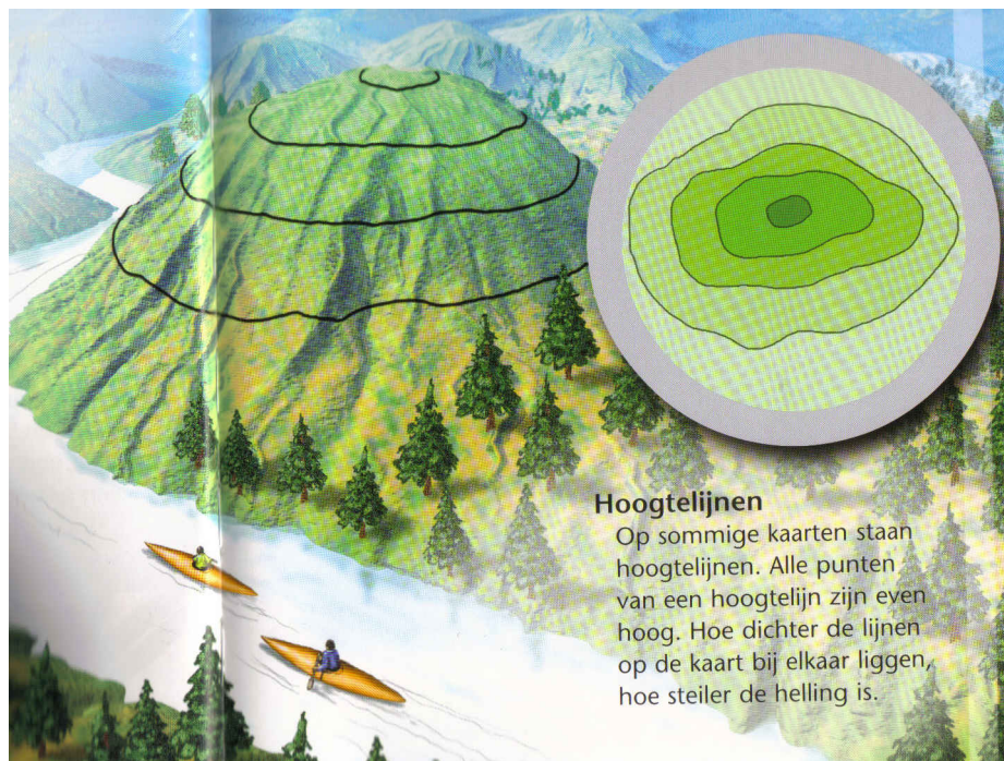
Figuur 2: Een berglandschap (zijaanzicht) en de bijbehorende 2D-contourlijnen.
